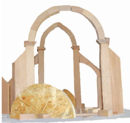
Les maquettes d'arcs brisé et plein-cintre.
